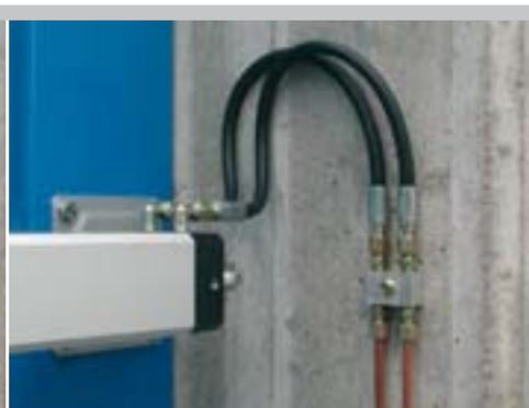
Connexion sur le bloc de dérivation avec raccords à 4 voies
